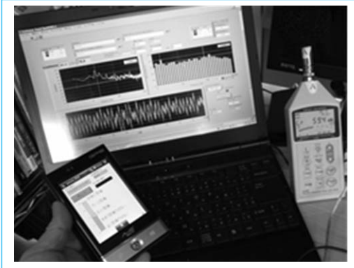
그림 5 저주파소음과 주관적 반응의 동시측정 시스템 예
